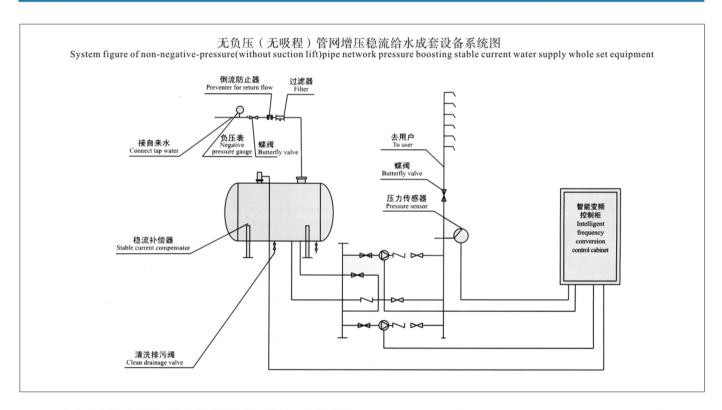
1、当自来水的压力低于用户所需的设定压力时,控制系统会自动控制变频器变频软启动运行,直到用户管网的实际工作压力等于设定压力,变频器控制变频泵以一恒定的转速运行,自来水的压力越高,变频泵的转速就越低,自来水的压力越低,变频泵的转速就越高,当自来水的压力等于设定压力时,变频泵就延时休眠,即充分利用了自来水原有的压力,以确保用户所需要的压力恒定。当压力下跌到唤醒值时,水泵自动唤醒。
